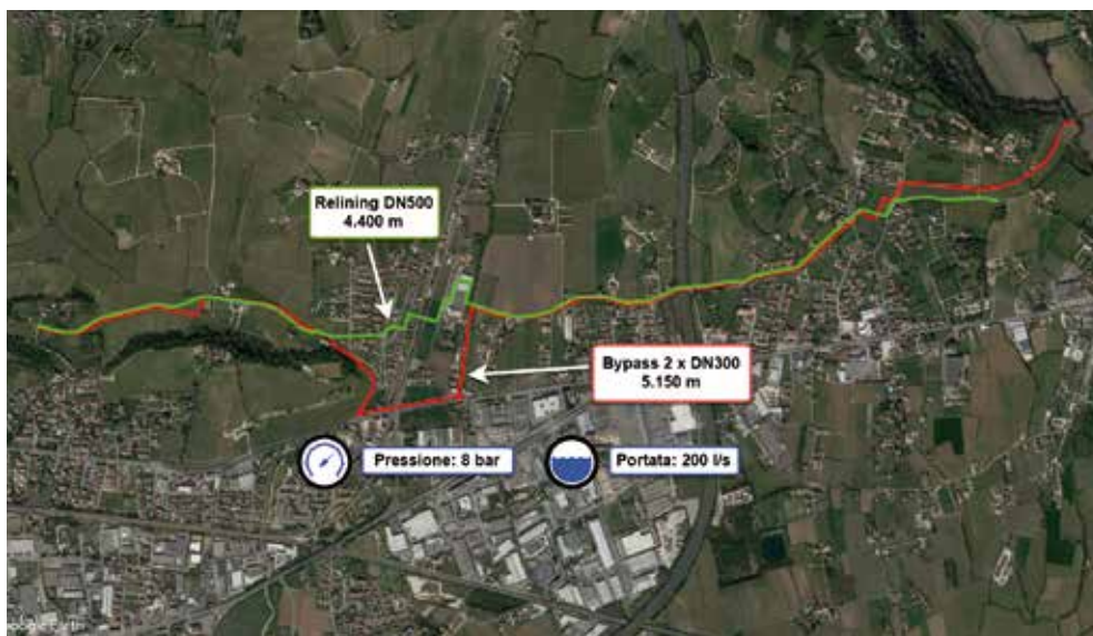
Percorso bypass e adduttrice risanata
