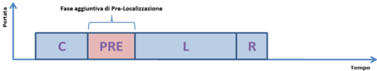
Rappresentazione temporale della risoluzione di una perdita mediante utilizzo di termografia/onde radar
