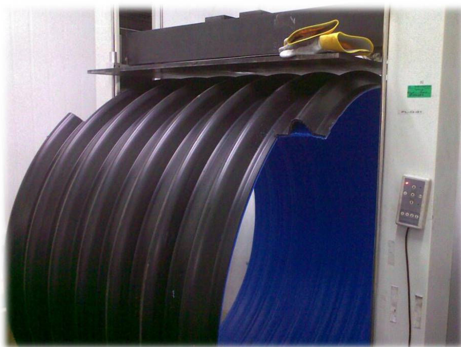
Figura 8. Tubo PALADEX durante la prova di deformazione.
