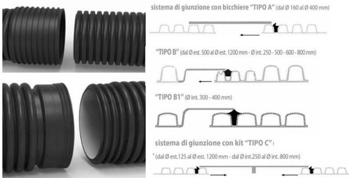
Figura 7. Corrugato in PP - Sistemi di giunzione con bicchiere "TIPO A – TIPO B – TIPO B1 – TIPO C".
