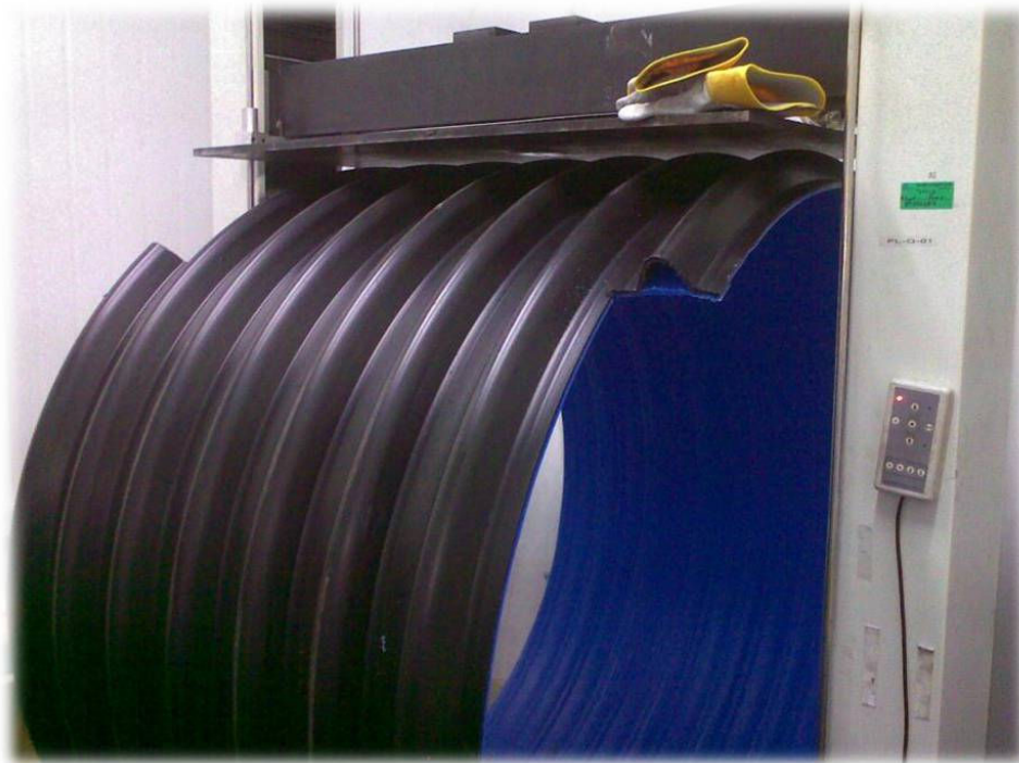
Figura 8. Tubo PALADEX durante la prova di deformazione.
