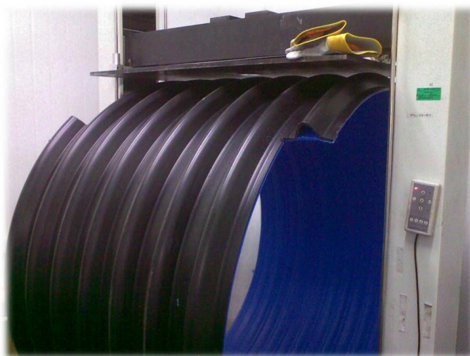
Figura 3. Tubo sottoposto alla prova di deformazione.
